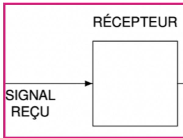
Le **récepteur** effectue généralement l'opération inverse de celle effectuée par l'émetteur, en **reconstruisant le message** à partir du signal.
