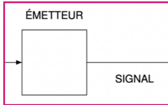
Un **émetteur** qui opère sur le signal d'une manière ou d'une autre pour **produire un signal adapté** à la transmission sur le canal. Quelques exemples :
