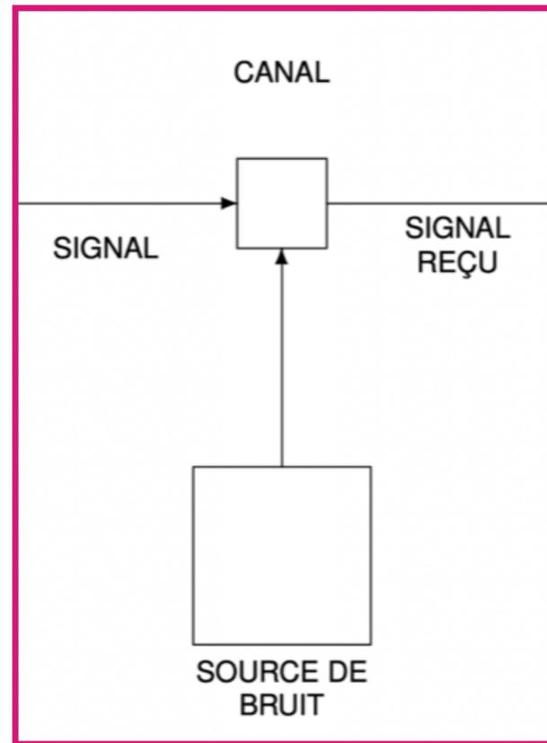
Le **canal** est le support utilisé pour **transmettre le signal** de l'émetteur au récepteur.
